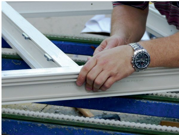
Schließteilverschrauben am Element: Alles andere als ergonomisch.
