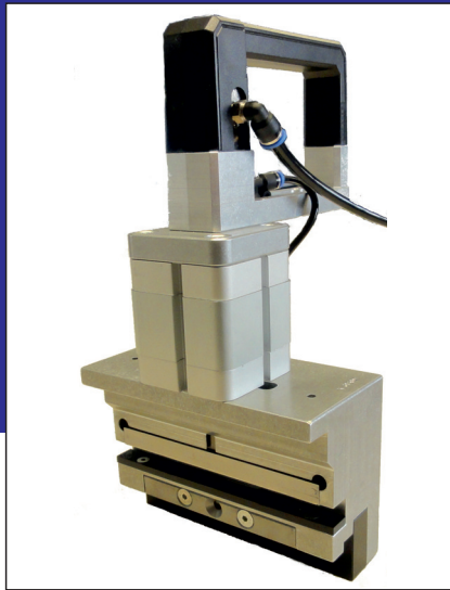
Mit einer pneumatischen Handstanze geht's deutlich schneller.
