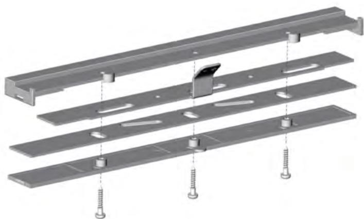
Der neue Lüfter verfügt im Inneren über zwei Ebenen, die gleichzeitig verschoben werden.
