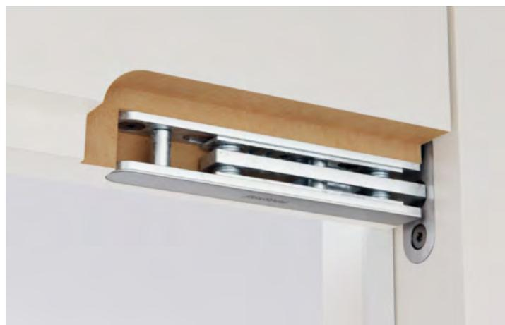
Der dreidimensional justierbare Blendenhalter für die Oberblende besteht aus massivem Stahl.
