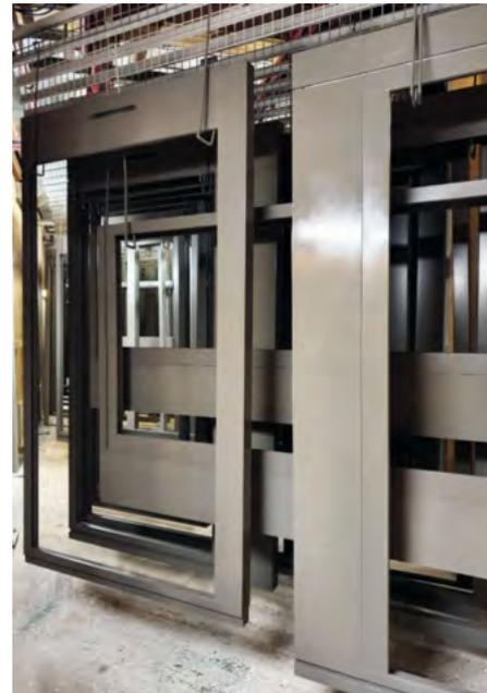
In den Wenger-Hallen werden die mehr als 6.500 Fensterelemente mit Adler Aquawood Covatop XT samt Anti-Heat-Zusatz in einem schlammgrauen Farbton lackiert.
