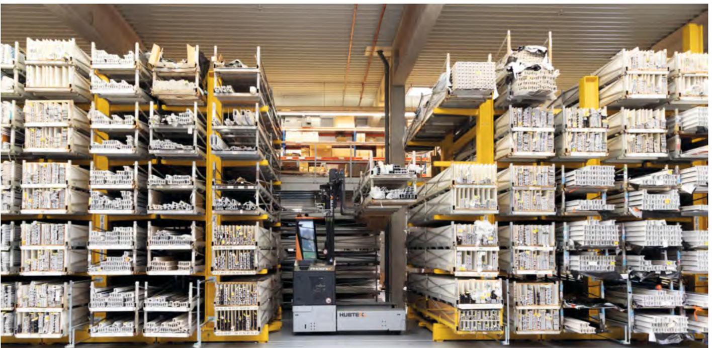
Das Hegla-Lagersystem ermöglicht eine platzsparende Lagerung der vielfältigen Bauteile. Abbildung: Schmidt.
