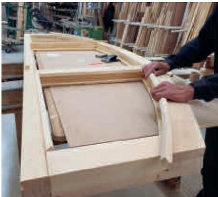
*Einblick in die Fertigung: Anpassung der Glasleistenrahmen.*
