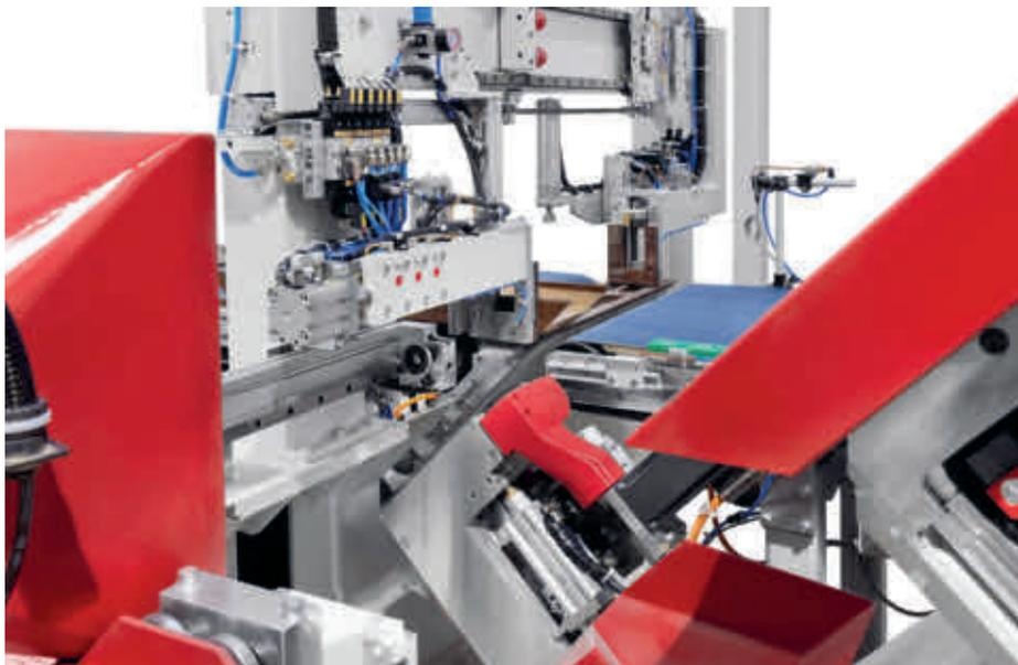
Die Anlage ZKA-598 ermöglicht Eckverbindungen von 90 und 45 Grad mittels der schwenkbaren Sägestation.
