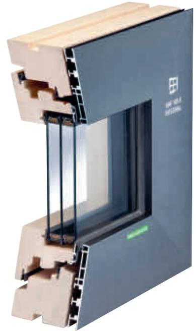
*Optisch rahmenlose Ansichten bietet das Holz/Aluminium-Fenster AHF 105 S Integral. Bei diesem durchweg puristischen System lässt sich der Blendrahmen komplett überdämmen, sodass fast nur noch Glas in der Fassade sichtbar ist. Abbildungen: Kneer-Südfenster.*
