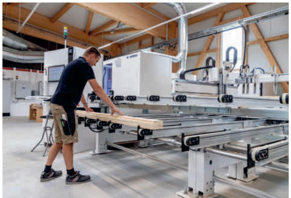
Auf der neuen Centateq S-800 können bis zu 25 Werkstücke mit einer Länge von bis zu sechs Metern aufgelegt werden.
