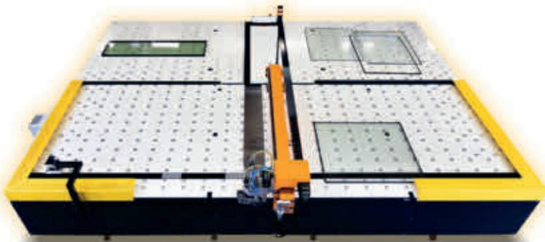
*Hegla bietet mit IG2Pieces eine Lösung zum Isolierglastrennen, die CO<sub>2</sub>-sparen und einen Mehrwert erzeugen kann.*
