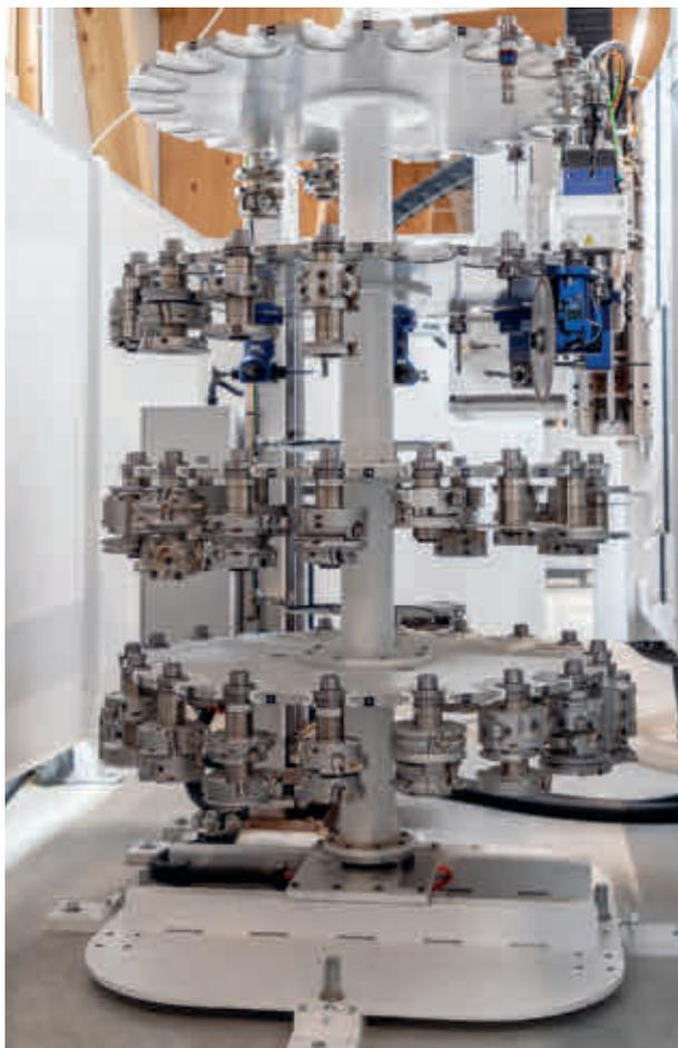
Zurzeit verfügt das Bearbeitungszentrum über 60 Werkzeuge der Firma Zuani.
