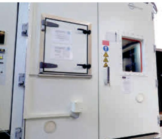
Im Klimaschrank des ift-Glaslabors wird MIG einem beschleunigten Alterungsverfahren ausgesetzt. Foto: ift Rosenheim
