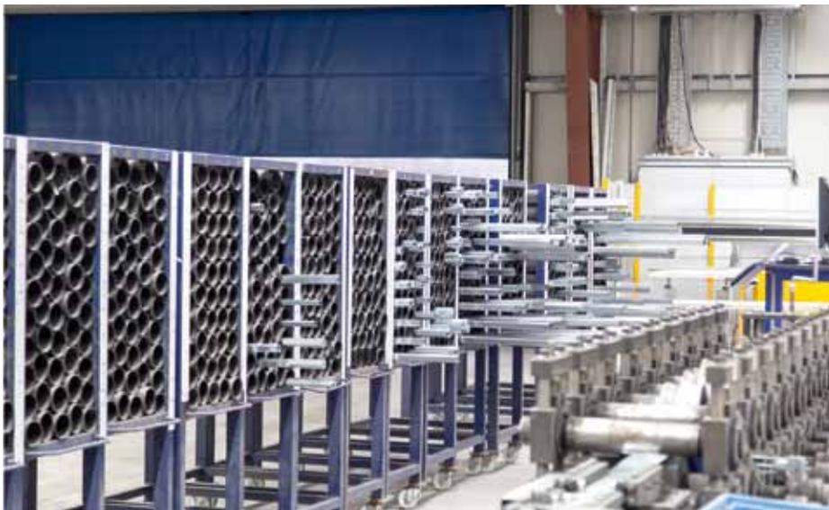
*Etliche Fensterhersteller setzen auf den passgenauen Zuschnitt der Stahlverstärkung umeine feste Verschraubung der Eck- und Scherenlager zu gewährleisten.*
