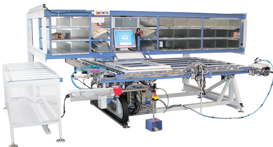
Rotox Flügelbeschlagautomat FBA 644 mit einer Schraubachse.
